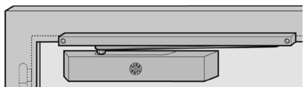
T46G: Montaje invertido en el lado de apertura.
