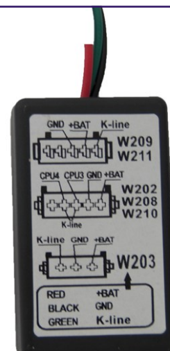
Emulador para Mercedes Bloqueo de dirección.
