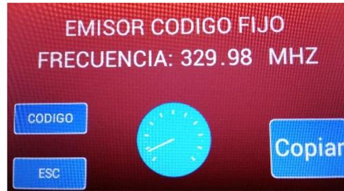
Após a análise das duas transmissões na ecrã, o tipo de código e a frequência são indentificados. Podemos também visualizar um gráfico do tipo de emissão e a “BASE TIEMPO” seleccionando a tecla 'CODIGO' ou podemos continuar o processo de cópia seleccionando 'COPIAR'
