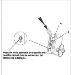
Extraer el pestillo central con ayuda de la llave y recolocar el bulón de bloqueo (B) 3 mm aproximadamente hacia arriba (con un destornillador por ejemplo).
