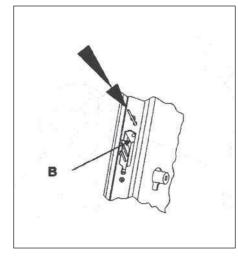
Manteniendo el bulón de bloqueo (B), retirar el destornillador del agujero (A) e introducir en su lugar un pasador de Ø 2 mm y de 30 mm mínimo, para evitar su disparo. La puesta en servicio se efecturará de forma clásica, una vez solventada la anomalía.
