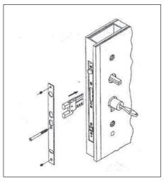
Insertar el nuevo cilindro monobloc comprobando, con la ayuda de la llave en el cilindro interior, que la linterna esté situada en su posición correcta (elevar el puente de condenación), girar la llave 45°, en sentido de "salida de los pestillos".
