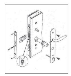
Desmontar el equipamiento interior, destornillar la sujeción del cilindro situada en la falsa testera así como la citada testera. Bajar la arandela de retención de salida del pestillo central y extraerlo haciendo girar la llave en sentido del cierre.
