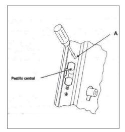
Con los pestillos en posición "PESTILLOS DENTRO", introducir un destornillador de punta redonda Ø 2 mm en el orificio del pasador de bloqueo (A) y mantener una presión constante sobre este destornillador, durante toda la secuencia de operaciones.
