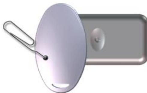
**9-EL LED DEL MANDO "AIR4" PARPADEARÁ RÁPIDAMENTE; PULSAR EL BOTÓN DÓNDE SE MEMORIZARÁ EL CÓDIGO Y MANTENER APRETADO HASTA QUE EL LED SE APAGUE.**
