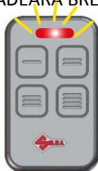
**8-SIMULTÁNEAMENTE, APRETAR LOS DOS BOTONES 1 Y 2 EN EL MANDO BFT Y SOLTAR INMEDIATAMENTE HASTA QUE EL LED EMPIECE A PARPADEAR (TRANSMISIÓN DE CÓDIGO FUENTE).**
