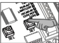
**02** • Pressione a tecla SET durante 10 segundos! O LED CODE apaga e todos os comandos foram apagados.
