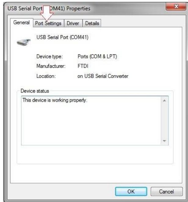
Aquí se observa que el número del Puerto seleccionado por el dispositivo es COM41 este se puede seleccionar y cambiar. Haga click en la flecha roja y se desplegará una lista desplegable con la selección de puertos.
