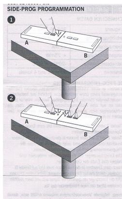
Colocar ambos emissores sobre uma superfície plana (não metálica), de forma que estejam em contacto pelo LED (indicador luminoso), e proceda da seguinte maneira:
